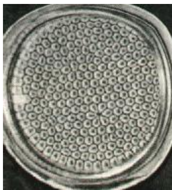
рис.5 Шестиугольные конвективные ячейки Бенара в силиконовом масле на равномерно нагретой медной пластинке.
