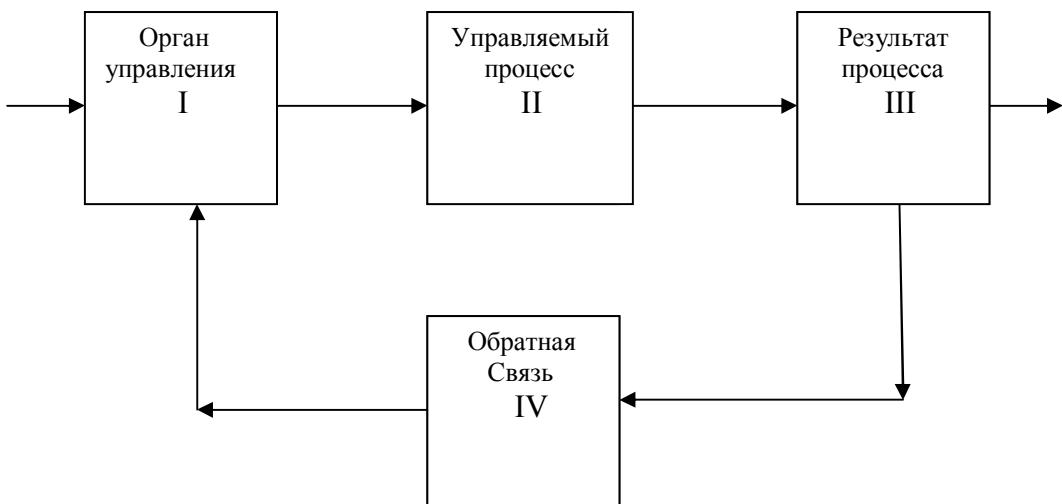
Рис. 1 Упрощенная схема обратной связи произвольного процесса.
